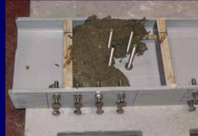
1. Furação dos perfis 2. Colocação dos conectores 3. Betonagem dos apoios
