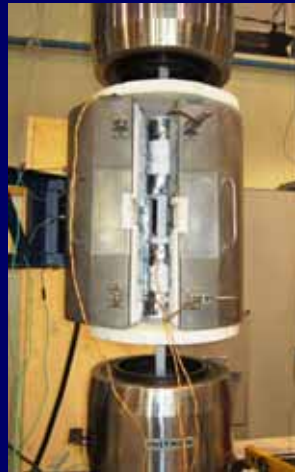
Ensaio de corte em laminados de GFRP a temperatura elevada (20-250°C)
