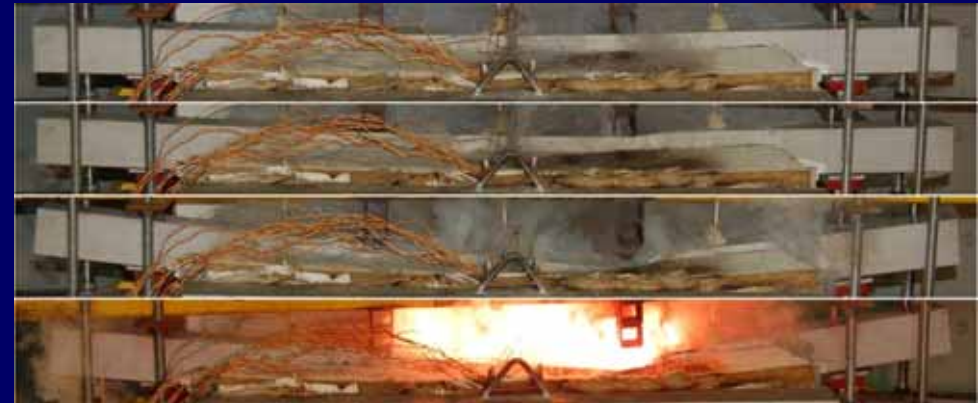
Ensaio de resistência ao fogo (ISO 834) de viga em GFRP protegida com placa SC – sequência de rotura
