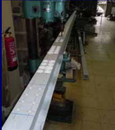
1. Furação dos perfis 2. Colocação dos conectores 3. Betonagem dos apoios
