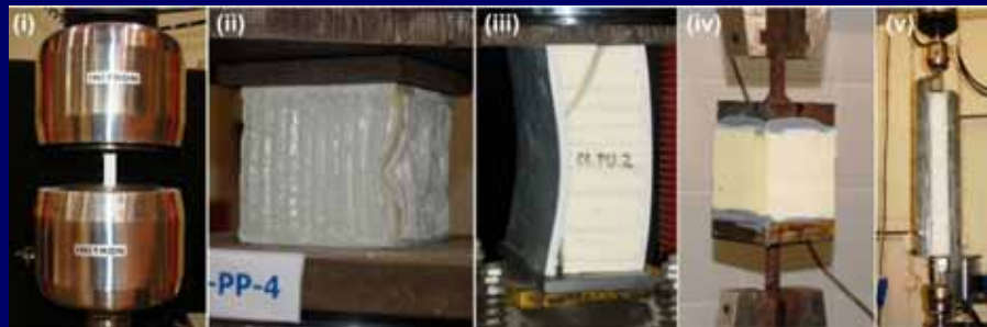
Ensaio de caracterização dos materiais (lâminas em GFRP, núcleos em espuma rígida de poliuretano e favos de mel em polipropileno)
