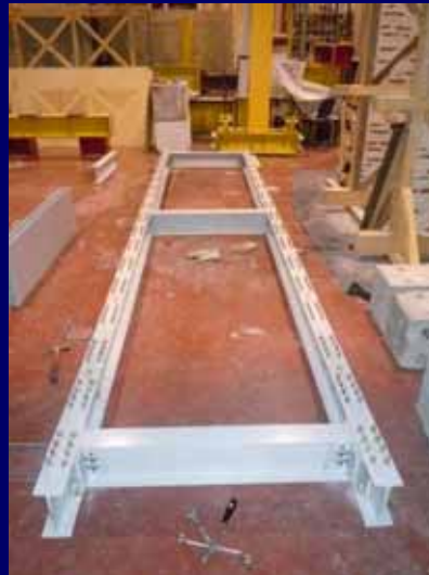
4. Montagem das vigas e contraventamentos
